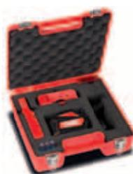
Lieferumfang Grundgerät: autoCROSSplus, magnetische Wandhalterung mit 1/4"- und 5/8"-Stativanschluss, Laserzieltafel, Batterien und Koffer.
