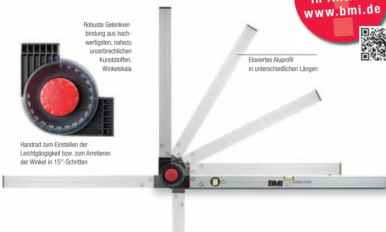
Robuster, zusammenklappbarer Bauwinkel **zum stufenlosen Übertragen oder Abnehmen von Winkeln von 0° bis 270°**. In 15°-Schritten können die Winkel fest arretiert werden. Durch die eingebauten Libellen als Wasserwaage verwendbar. Leicht zu transportieren. In unterschiedlichen Größen lieferbar.
