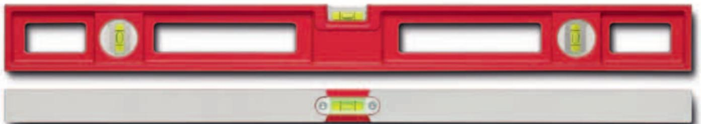
Schwere Aludruckguss-Wasserwaage, umlaufend gefräst. Rot pulverbeschichtet. Sehr hohe Verwindungssteifigkeit. Durchgriffe für leichte Handhabung. Messgenauigkeit in Normallage 0,5 mm/m. Die Längen 060 S und 080 S sind mit zwei V Libellen ausgestattet.
