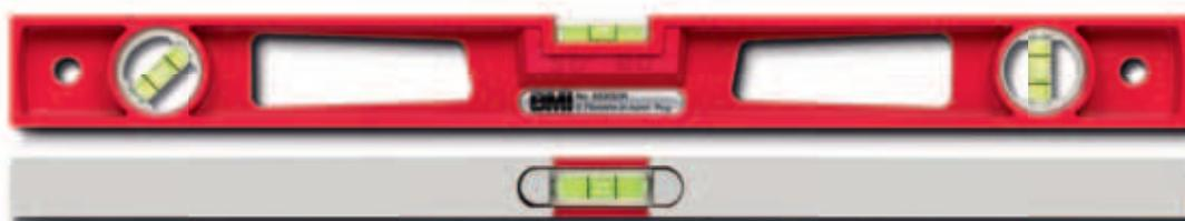
Aludruckguss-Wasserwaage, umlaufend gefräst. Rot pulverbeschichtet. Hohe Verwindungssteifigkeit. Durchgriffe für leichte Handhabung. Mit 45 Grad Libelle. Messgenauigkeit in Normallage 0,75 mm/m.
