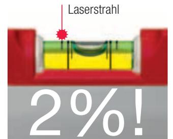
Die 690 EUROSTAR wird komplett montiert. Die Libellen haben zu diesem Zeitpunkt noch keine Markierungsringe. Als letzten Arbeitsschritt misst ein Computer die Lage der Libellenblase aus und steuert einen Laser, der in genau gleichen Abständen neben die Blase Markierungen in das Libellenmaterial brennt.
